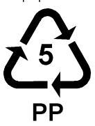
El PP es un plástico que según como se formule y combine se pueden obtener desde materiales muy flexibles y elásticos hasta materiales rígidos. Es traslúcido, resistente al impacto y tiene alta rigidez y dureza. Con el PP se elaboran envases para alimentos (helados, margarinas), envases para pinturas y también rejas para frutas. La película de PP bi orientada (BOPP) se utiliza para el envasado de
