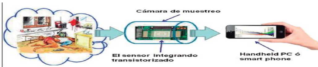
IMAGEN 36. Esquema que muestra los pasos que se desarrollan en la captación, identificación y cuantificación de olores en la escena del delito. El olor ingresa en la cámara de muestreo, posteriormente el detector integrando transistorizado identifica y cuantifica las sustancias volátiles y, finalmente, el software de una computadora, handheld o smart phone recibe y procesa la señal de la nariz electrónica. (8)
