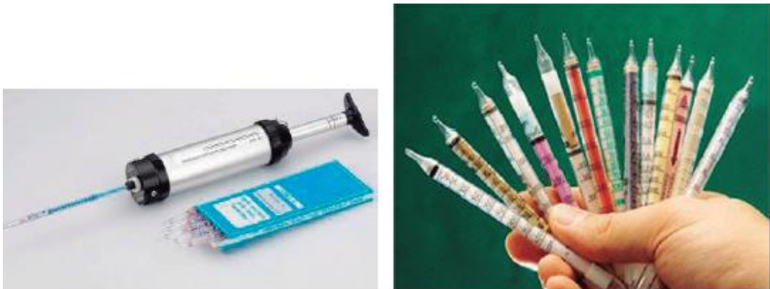
IMAGEN 35. En la figura se muestran las jeringas que permiten muestrear el aire del lugar del hecho y luego, utilizando diferentes tubos detectores, identificar y cuantificar las sustancias volátiles de interés pericial. (8)
